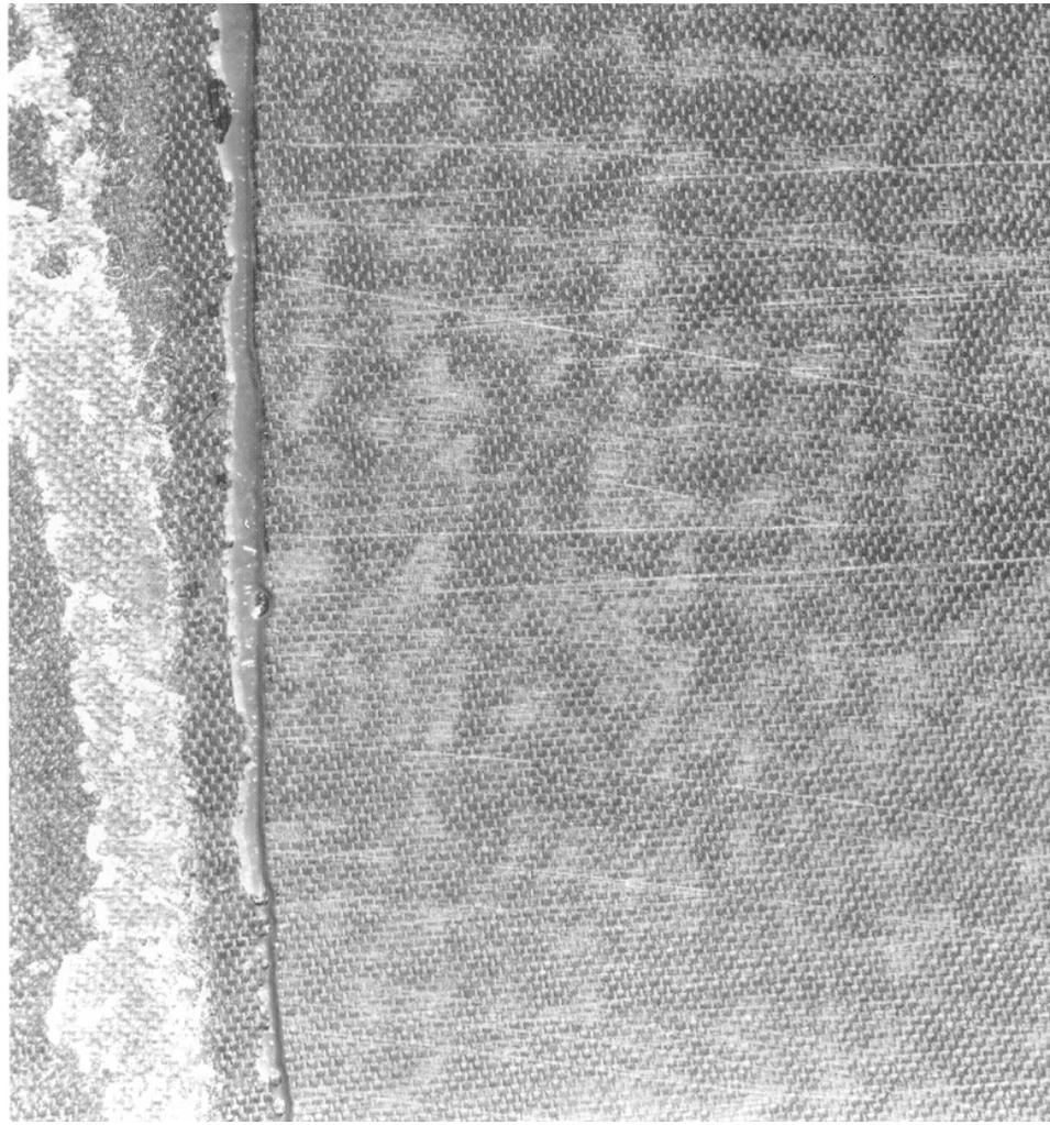
**LIGHTLY GRIT-BLASTED COMPOSITE SURFACE, RETAINING IMPRINT OF PEEL PLY AND SHOWING NO DAMAGE TO UNDERLYING FIBERS**
